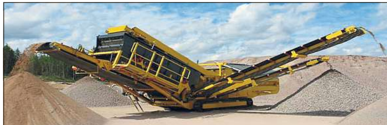
Zu schade für die Deponie: Aufbereiteter Bauschutt eignet sich nicht nur als Füllmaterial im Wege- und Tiefbau, sondern auch für die Herstellung von Beton für Fertigteile, beweist das Unternehmen aus Heek.
